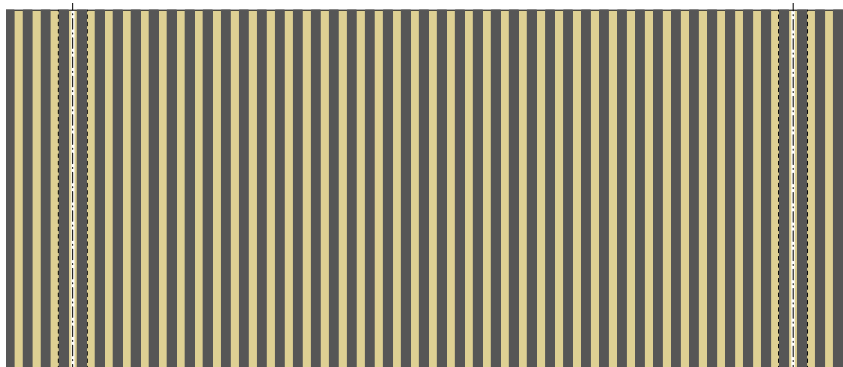
Lärmschutzwand Ansicht Holzkonstruktion Innen
